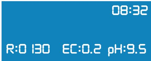
In origine il programmatore non ha nessuna programmazione in memoria per cui visualizza i valori di default riguardanti ora, irraggiamento, conducibilità e pH.
