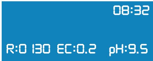
Su questa schermata, oltre all'indicazione costante dell'ora attuale, vengono visualizzati i valori di irraggiamento, conducibilità elettrica e pH, rilevati dalle sonde analogiche collegate al programmatore.
