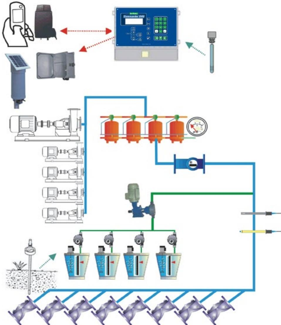
Nella figura si possono osservare le sue potenzialità, tuttavia occorre tener presente che il programmatore **COMMANDER EVO PLUS** può essere configurato in funzione dell'impianto; nella figura precedente, per esempio, non si hanno i filtri per cui si possono sfruttare altre 4 valvole di campo.
