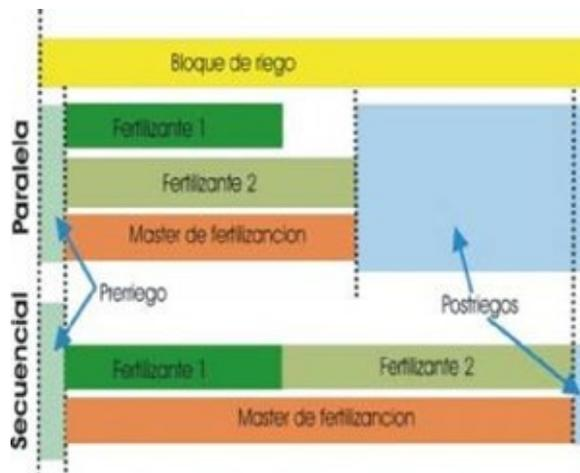
**Nota:** Nel caso che il tempo di fertilizzazione fosse superiore al tempo totale del blocco, la fertilizzazione si fermerà alla fine del blocco. In caso di funzionamento con irrigazione simultanea non è possibile la fertilizzazione sequenziale (vedere sezione Simultaneità).
