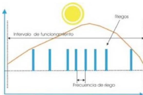
Come si può osservare nella figura precedente, il programmatore accumula le radiazioni per metro quadro entro un intervallo di ore impostato. Al raggiungimento del valore prefissato dall'utente, si avvia l'irrigazione, il contatore di irrigamento accumulato si azzerava e riparte l'accumulo.
