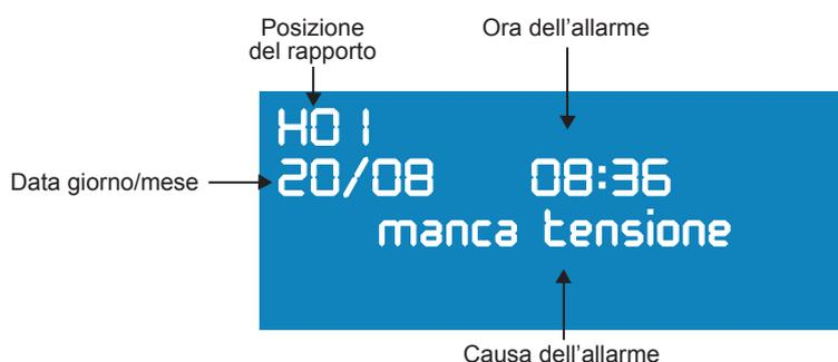
Le possibili cause di allarme indicate in questo rapporto sono: calo di tensione, contatore dell'acqua, contatore dei fertilizzanti, allarme dalla sonda dell'olio, da portata nominale o allarme da ingresso esterno.
